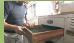
Con la macchina asciugatrice l'umidità nelle foglie viene ridotta al 5%
